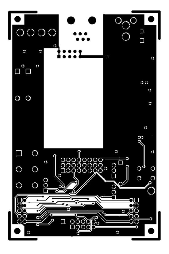
Figure 12. Si30xxSSI-EVB Solder Side
