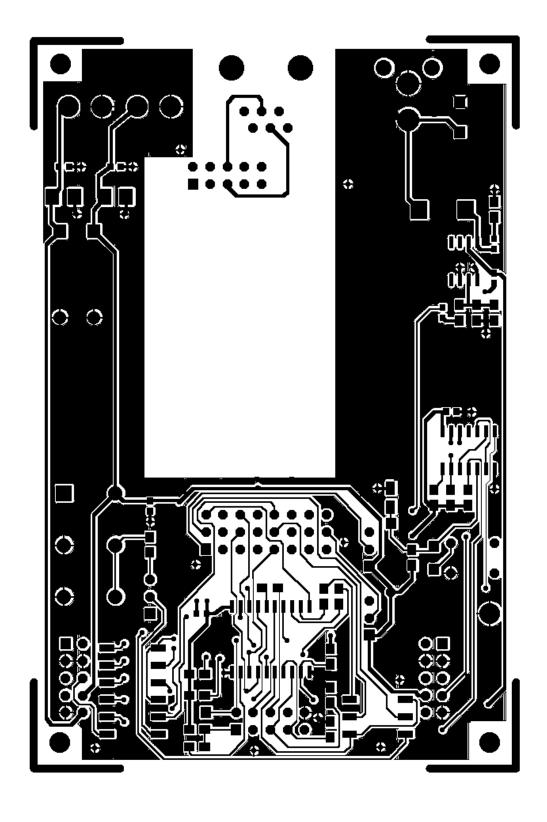
Figure 11. Si30xxSSI-EVB Component Side
